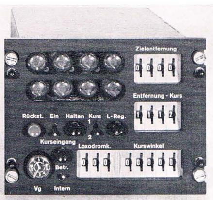
Bedien- und Anzeige-Gerät zum Doppler-Digitalrechner im Flugzeug
