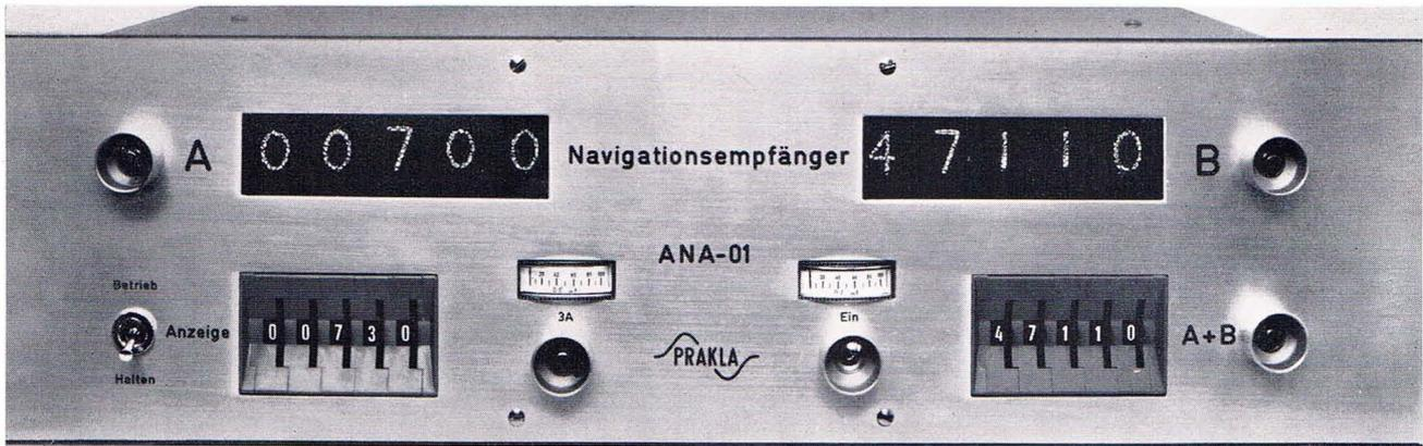
Navigationsempfänger volltransistorisiert 1,8 MHz 0,1  $\mu$ V
